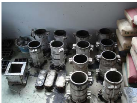
ภาพที่ 27 แบบหล่อคอนกรีตและมอร์ต้าร์
