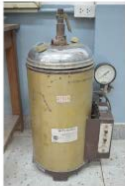
43. ชุดทดสอบการขยายตัวของซีเมนต์ โดยการต้มด้วยไอน้ำแรงดันสูง (SOUNDNESS OF CEMENT BY AUTOCLAVE METHOD)
