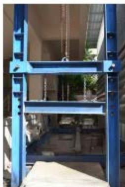
45. การทดสอบหาคอนกรีตเสริมเหล็กสำหรับงานระบายน้ำ โดยวิธีกำลังรับ แรงอัด (THREE-EDGE BEARING TEST OF REINFORCED CONCRETE SEWER PIPE)
