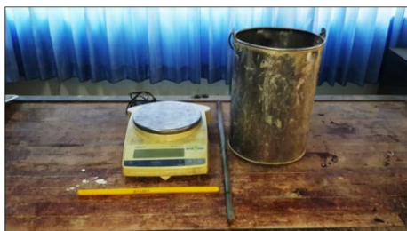
ภาพที่ 15 ชุดทดสอบการหาค่าหน่วย น้ำหนักของคอนกรีต
