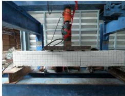
44. การทดสอบคานคอนกรีตเสริมเหล็ก เพื่อศึกษาพฤติกรรมการรับ แรงดัด (EXPERIMENTAL INVESTIGATION ON THE FLEXURAL BEHAVIOUR OF FULL-SIZE REINFORCED CONCRETE BEAM)
