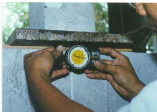
44.1 การวัดค่าการเปลี่ยนแปลงความยาว และความกว้างของรอยแตกบริเวณคาน คอนกรีตเสริมเหล็ก เมื่อรับแรงดัด (FLEXURAL STRAIN AND CRACK WIDTH MEASUREMENT OF REINFORCED CONCRETE BEAM)
