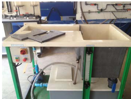
ภาพที่ 8 การหาอัตราการไหลผ่านฝายจำลองในโต๊ะชลศาสตร์
