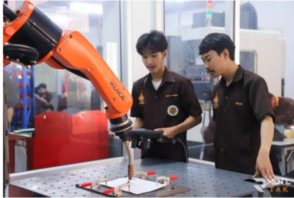
มีห้องเรียนเกี่ยวกับการควบคุมแขนกล หุ่นยนต์อุตสาหกรรมสำหรับงานเชื่อม
