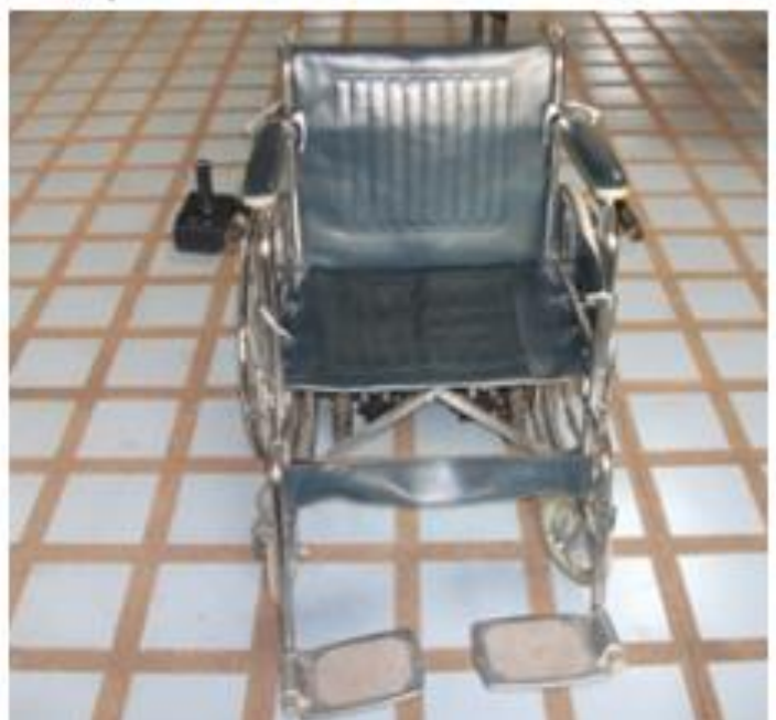
5) ชุดขับเคลื่อนไฟฟ้าเมื่อประกอบเข้ากับรถเข็นคนพิการ
