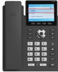
เลือก SSID ต้องการเชื่อมต่อจากนั้นกดปุ่ม Confirm
