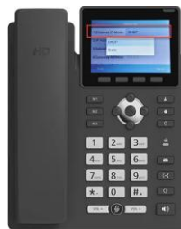
Ethernet IP Mode DHCP เลือกรับ IP-Address จาก Server Static เลือกตั้งค่า IP-Address
