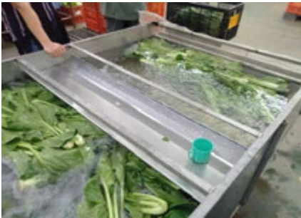
รูปที่ 34 ผักจะถูกกระแสน้ำดันออกไปในช่องเก็บผัก
