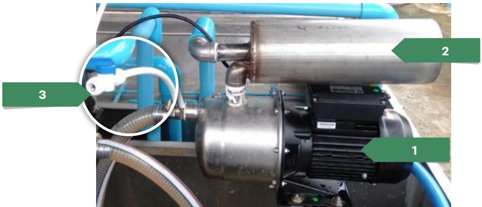
รูปที่ 15 ส่วนประกอบของระบบผลิตฟองอากาศขนาดจิ๋ว
