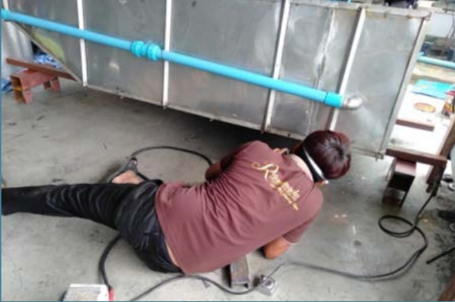
รูปที่ 12 การเชื่อมฐานเครื่อง
