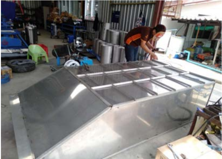
รูปที่ 11 การเชื่อมฐานด้านล่างของเครื่อง
