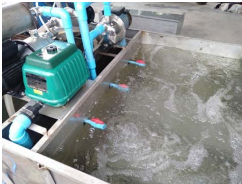
รูปที่ 30 ระบบการดันผักและคัตรูพีช ให้ลอยขึ้นสู่ผิวน้ำ
