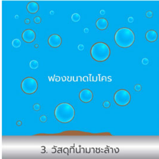
รูปที่ 4 ฟองอากาศที่ดูดจับสิ่งสกปรกจะแยกตัว
