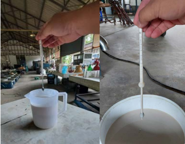
รูปที่ 26 ก่อนและ หลังจากการวัดค่าน้ำดิน ค่าความถ่วง จำเพาะ(ถ.พ) 1.60
