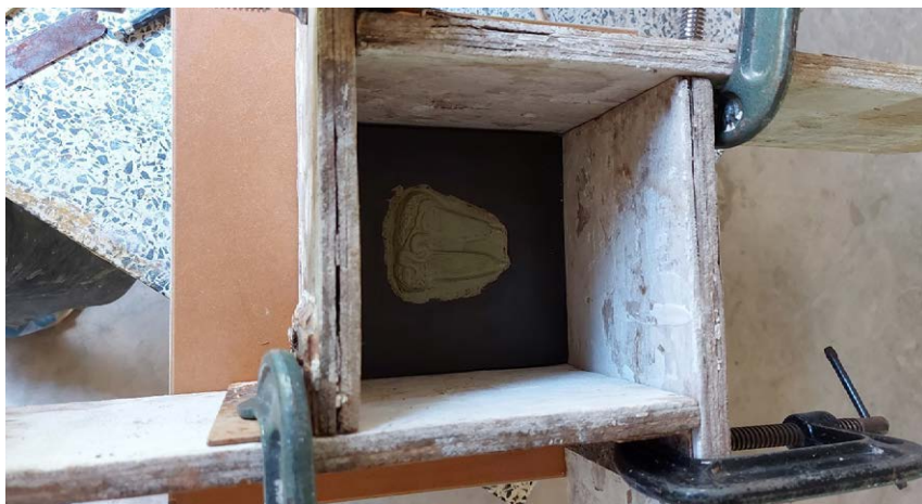
รูปที่ 5 กั้นต้นแบบโดยใช้ปากกากลับ ซีแคมป์ C-CLAMP
