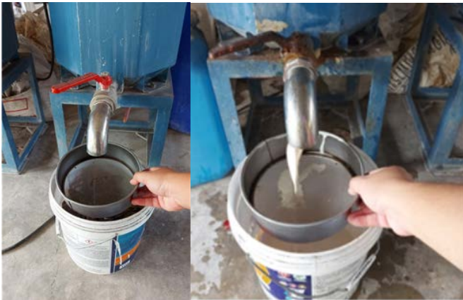
รูปที่ 27 กรองน้ำดินด้วยตะแกรง เบอร์ 80 เมช 1รอบ กรองรอบที่2 ด้วยตะแกรง เบอร์ 100 เมช 1 รอบ
