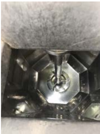
รูปที่ 21 นำน้ำสะอาดที่เตรียมเทลงใน ถังปั่นดิน 40 %
