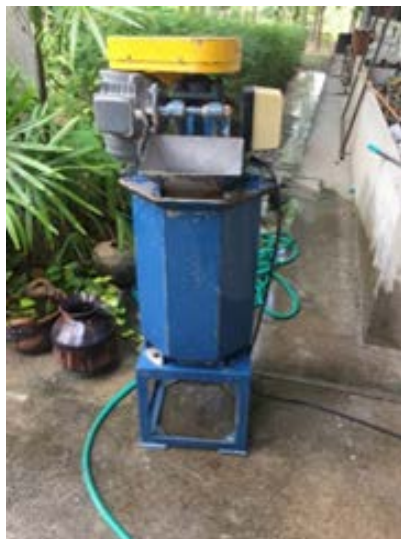
รูปที่ 20 ล้างทำความสะอาด หม้อป้อนก่อนเทน้ำ
