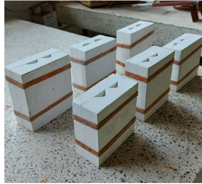
รูปที่ 29 ประกอบแบบพิมพ์และ รัตแบบพิมพ์ให้แน่น
