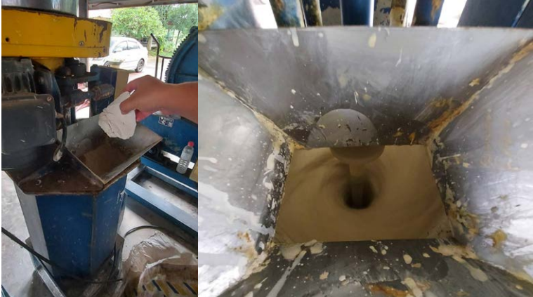
รูปที่ 23 นำดินที่ตัดเป็นก้อนเล็ก ๆ เทลงในถังปั่นรูปที่ใช้เวลาในการปั่นหรือบด 30-60 นาที
