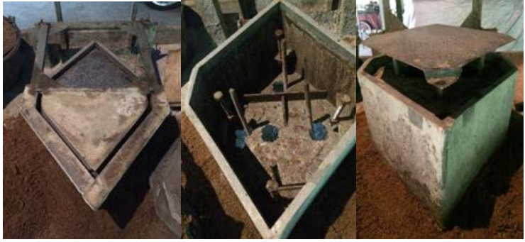
ภาพที่ 10 แบบพิมพ์กระเบื้องหลังคาโบราณด้วยซีเมนต์ วัตถุประสงค์
