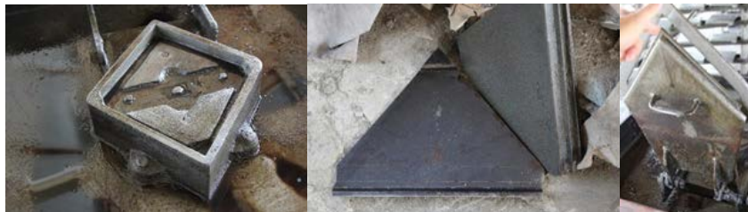
ภาพที่ 19 แบบพิมพ์โลหะกระเบื้องหลังคาโบราณด้วยซีเมนต์ โรงงานบ้านหยา
