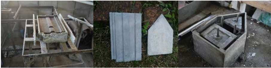
ภาพที่ 15 แบบพิมพ์กระเบื้องหลังคาโบราณด้วยซีเมนต์แบบลอน กระเบื้องว่าวปลายแหลม
