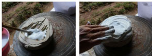
ภาพแสดงการใช้ฟู่กันเก็บรายละเอียดของต้นแบบแล้วพอกให้ได้ความหนาประมาณ 2.5 เซนติเมตร
