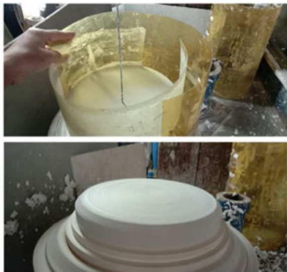
ภาพแสดงการแกะพลาสติกออกแล้วและเหล็กแหลมถึงจับศูนย์แล้วจึงให้ได้ขนาดตามแบบ
