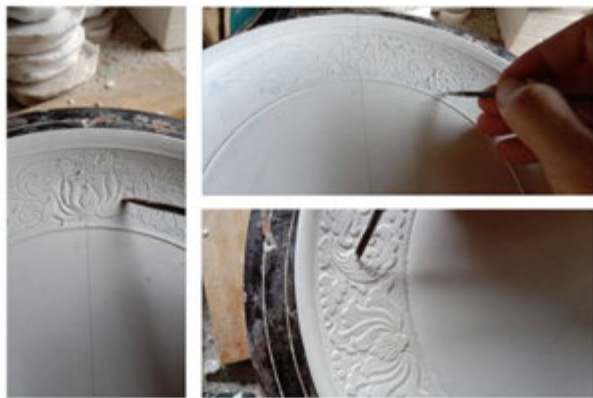
ภาพแสดงการร่างกตลวดลายและจัดมิติแกะสลักให้เป็นลวดลายแบบนูนต่ำ
