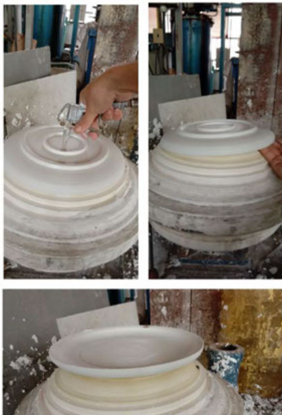
ภาพแสดงการเอาต้นแบบออกจากแท่นกลึงโดยใช้ลมเป่า
