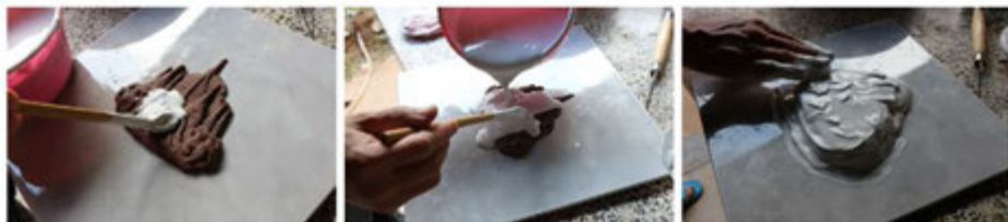
ภาพแสดงการใช้ฟู่กันทาเก็บรายละเอียดและพอกความหนาเพื่อทำแม่พิมพ์ทُب
