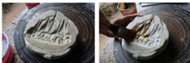
ภาพแสดงแม่พิมพ์ทُبและการทาน้ำสบู่ให้ทั่วแม่พิมพ์ทُب
