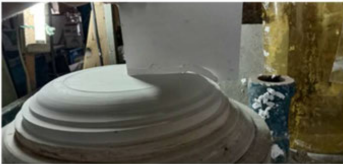
ภาพแสดงการวัดขนาดโดยใช้กระดาษแข็งที่ตัดเป็นรูปต้นแบบเพื่อวัดส่วนเว้าส่วนโค้ง
