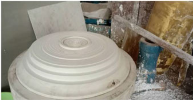
ภาพแสดงแท่นกึ่งที่หล่อเสริมด้วยปูนปลาสเตอร์
