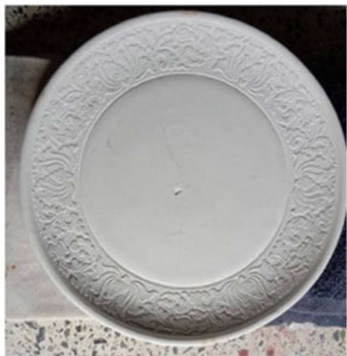
ภาพชิ้นงานต้นแบบที่สำเร็จที่ผ่านการกลึงและแกะสลักลวดลายแบบนูนต่ำ
