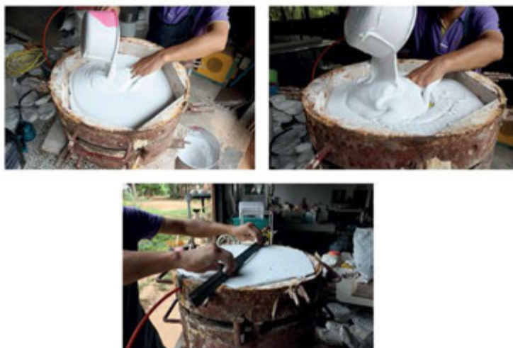
ภาพแสดงการเทปูนปลาสเตอร์แล้วปาดผิวหน้าให้เรียบเสมอบนขอบเหล็ก
