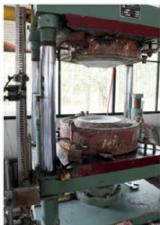
ภาพแสดงการเตรียมพิมพ์ในการขึ้นรูป
