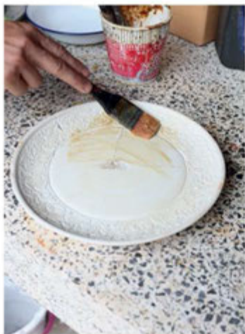
ภาพแสดงการทำน้ำสบู่ลงบนต้นแบบให้ทั่ว
