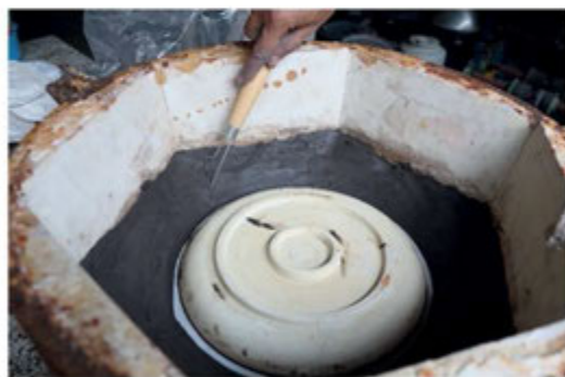
ภาพแสดงการแต่งผิวดินให้เรียบและทำความสะอาดต้นแบบ
