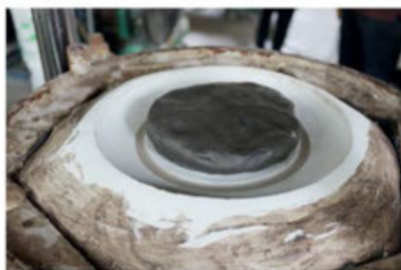
ภาพแสดงการนำดินวางกลางแม่พิมพ์ด้านล่าง
