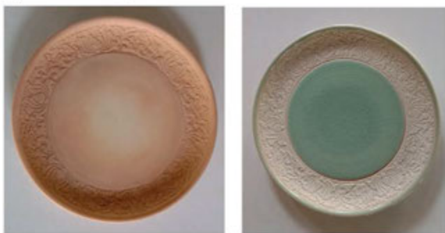
ภาพแสดงผลภัณฑ์ที่ขึ้นรูปด้วยเครื่องอัดแรงดันสูง ที่ผ่านการเผาบิสกิต และการเผาเคลือบ
