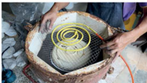
ภาพแสดงการวางสายลมพรุณบนตะแกรงภายในกรอบเหล็ก
