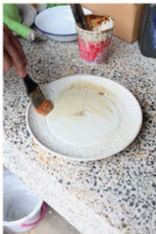
ภาพแสดงการทำน้ำสบู่ลงบนต้นแบบให้ทั่ว
