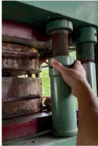
ภาพแสดงการปรับขาสำหรับค้ำยันให้ชนกับแท่นพิมพ์ด้านบน
