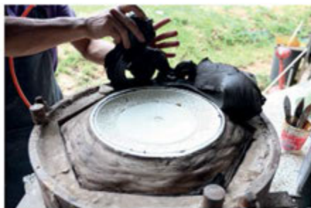
ภาพแสดงจับพิมพ์หงายเอาดินออกแล้วตกแต่งผิวปูนด้านข้างให้เรียบสไลด์
