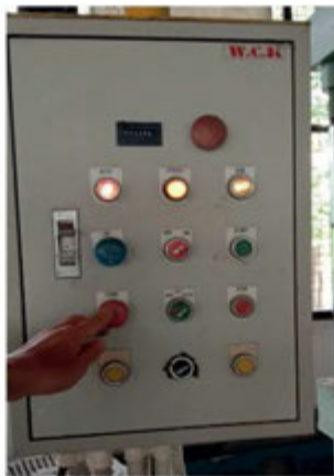
ภาพแสดงการกดสวิทซ์ Down ค้างไว้เพื่อให้แท่นพิมพ์ด้านล่างลง
