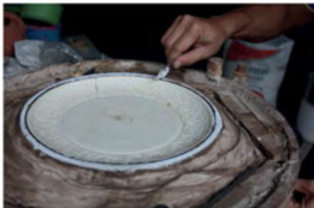
ภาพแสดงจับพิมพ์หงายเอาดินออกแล้วตกแต่งผิวปูนด้านข้างให้เรียบสไลด์
