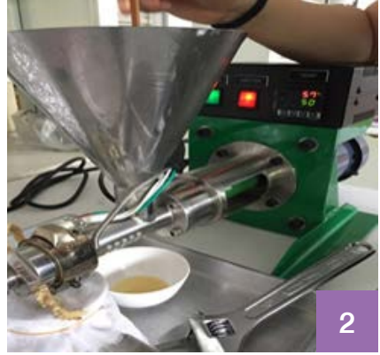
การสกัดน้ำมันมะกิงด้วยเครื่องแบบเกลียวหมุน
