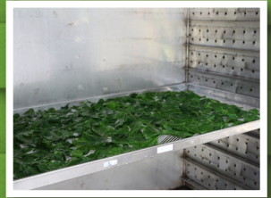
นำไปอบในตู้อบแบบภาคด้วยลมร้อน ที่อุณหภูมิ 60-65 °C นาน 4 - 6 ชั่วโมง
