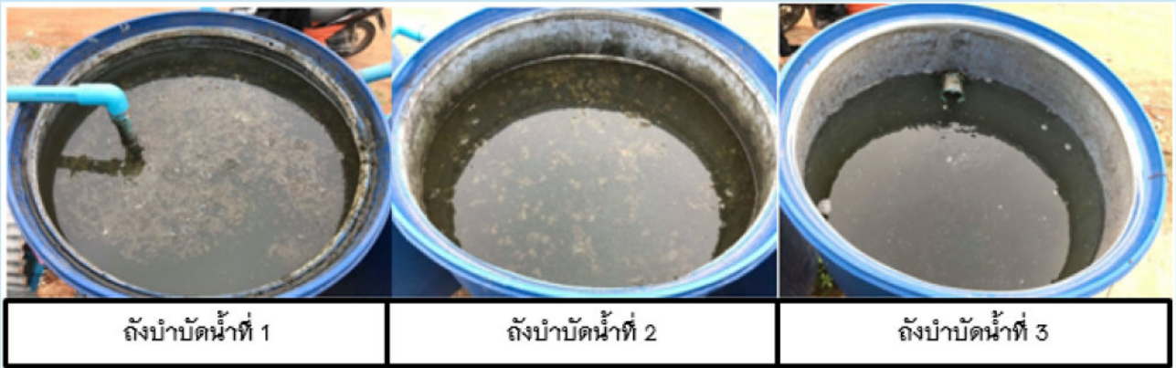
ลักษณะของซีปลาและสิ่งปฏิกูลลอยขึ้นมาหลังจากเปิดเครื่อง MNB (ถัง 1) และน้ำก่อนปล่อยลงบ่อ (ถัง 3)
