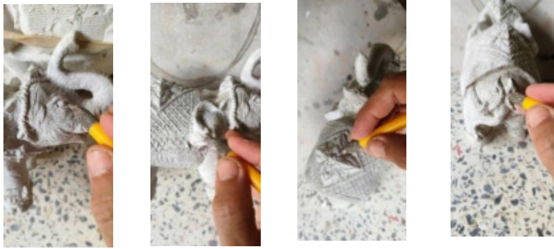
ภาพที่ 18-21 แสดงการตกแต่งรายละเอียดในส่วนต่างๆต้นแบบช้างให้มีความคมชัดสวยงามและหลีกเลี่ยงการถอดแม่พิมพ์ใช้งานเซรามิก
