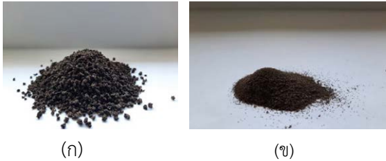
ภาพที่ 2 ขนาดโมเลกุลของกากงาหลังการร่อน (ก) 1680 ไมครอน (ข) 149 ไมครอน
