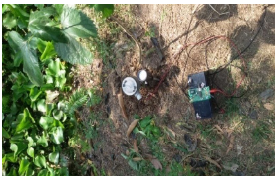
รูปที่ 3 การทดสอบชุดควบคุมน้ำหยดอัตโนมัติ และการวัดความชื้นในดิน
