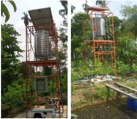
รูปที่ 4 โครงสร้างการออกแบบและสร้างระบบจ่ายน้ำหยดในสวนสมุนไพรอัตโนมัติจากพลังงานแสงอาทิตย์
