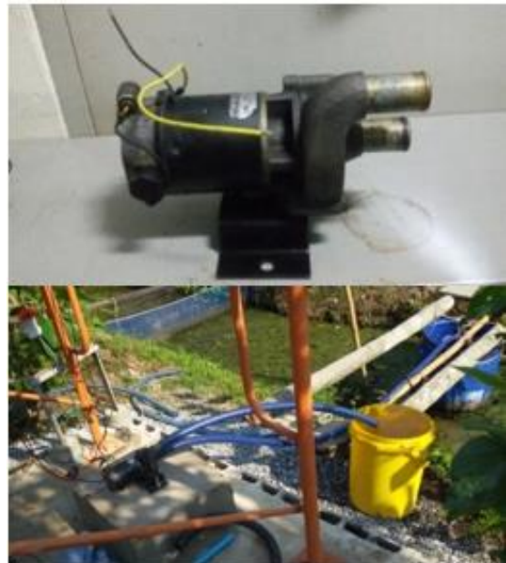
รูปที่ 1 มอเตอร์ปั๊มน้ำไฟฟ้ากระแสตรงแบบแรงเหวี่ยงหนีศูนย์กลาง และการทดสอบมอเตอร์ปั๊มน้ำ
