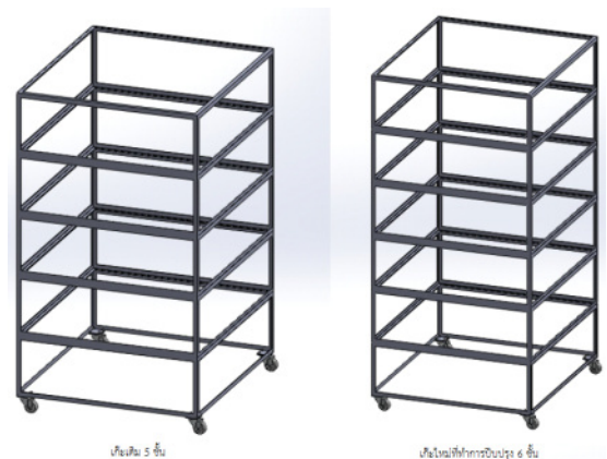
รูปที่ 3 ลักษณะของเก๊ตกายแบบ 5 ชั้น และแบบ 6 ชั้น
