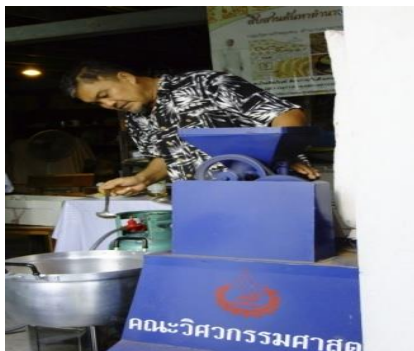
รูปที่ 2 ตัวแทนชุมชนกำลังทดสอบเครื่องบดผงกะหรี่
