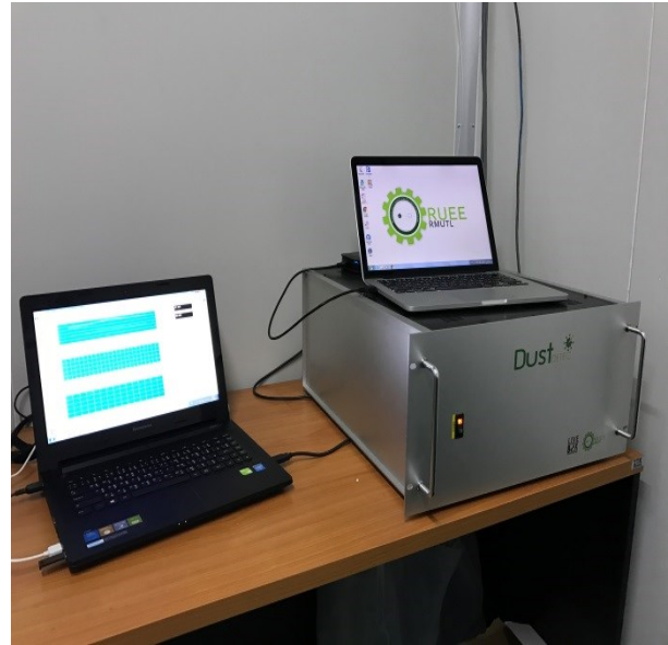
(ข) เครื่องวัดปริมาณมวลฝุ่นละออง PM10 และ PM2.5
