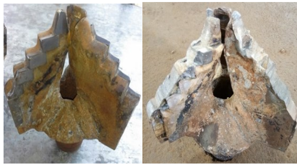
ภาพที่ 2 การสึกหรอของหัวเจาะบริเวณกัดและใบกัด (สุรพิน และ สุทธิเทพ ,2559)
