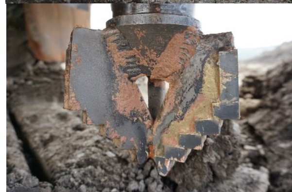
ภาพที่ 10 ทดสอบการเจาะชั้นหินกรวดมน ณ การไฟฟ้าฝ่ายผลิตแห่งประเทศไทย (เหมืองแม่เมาะ)
