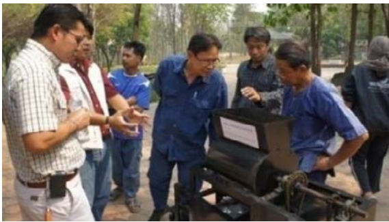
ภาพที่ 8 การทดสอบสมรรถนะของเครื่องนวดส่วนผสมดินกับผงแร่เหล็กน้ำพี้
