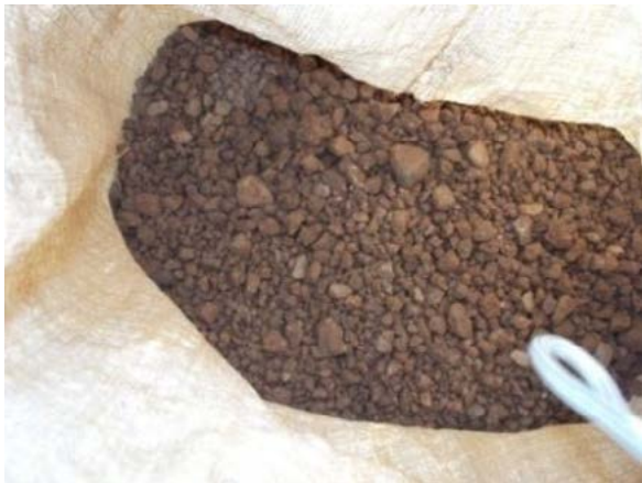
ภาพที่ 3 ลักษณะของแร่เหล็กน้ำพี้ที่ขุดพบ
