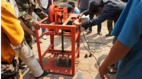
ภาพที่ 7 การทดสอบสมรรถนะของเครื่องตำผงแร่เหล็กน้ำพี้
