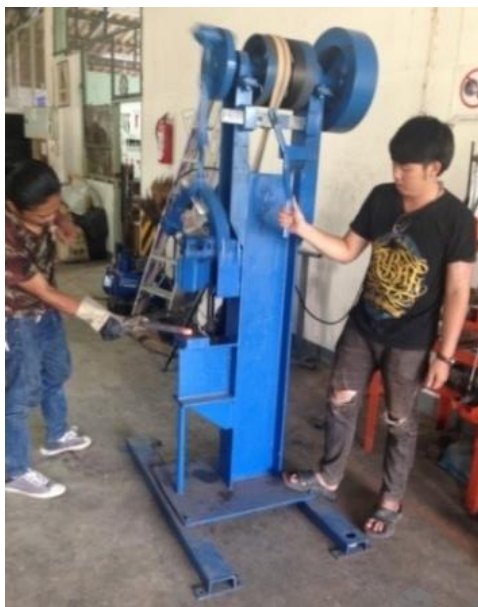
ภาพที่ 9 การทดสอบสมรรถนะของเครื่องตีดาบและมิตเหล็กน้ำพี้
