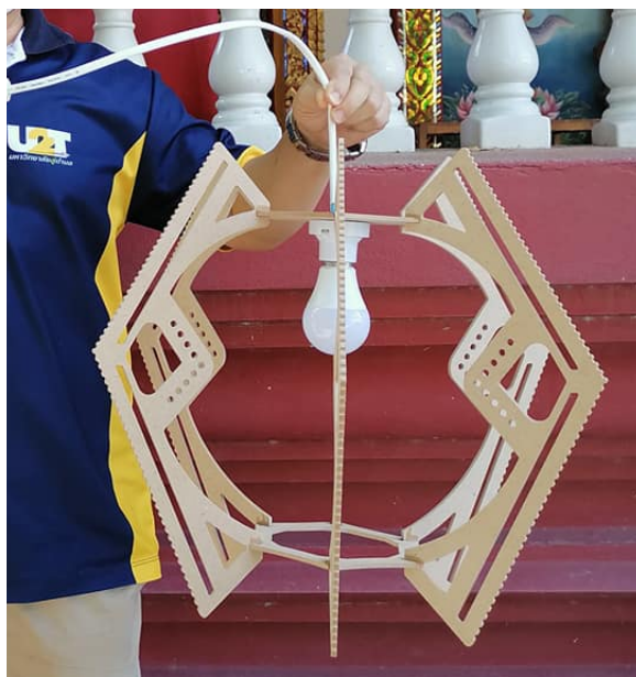
รูปที่ 5 แสดงการประกอบขึ้นโครงสร้างเข้าด้วยกัน ยึดด้วยกาวร้อนหรือกาวลาเท็กซ์ให้แน่น ให้ได้ตามแบบ
