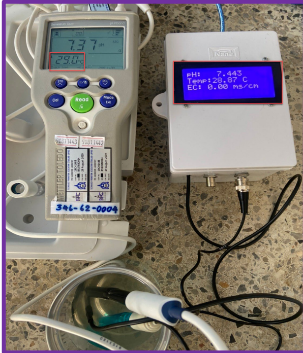
รูปที่ 2 เปรียบเทียบการวัดระหว่างเครื่องวัดต้นแบบกับเครื่องวัดคุณภาพน้ำรุ่น SG23-FK2-Kit
