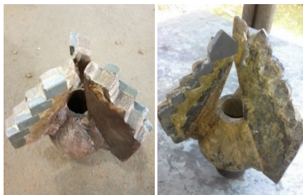
ภาพที่ 4 การสึกหรอของหัวเจาะที่ทำการเจาะชั้นหินกรวดมน., สุรพิน และ สุทธิเทพ (2559)
