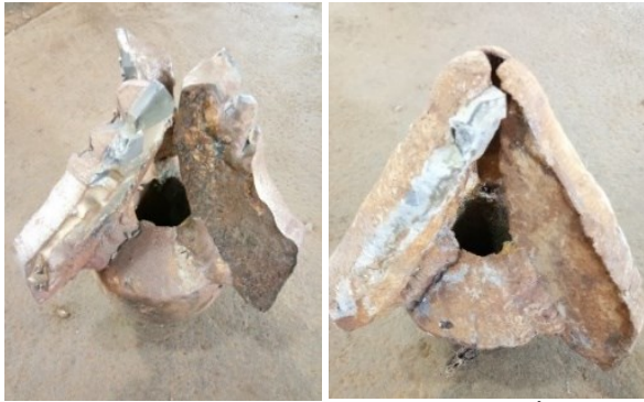
ภาพที่ 5 การสีกหรือของหัวเจาะที่ทำการเจาะชั้นหินดิน ฉนวน., สรุพิน และ สุทธิเทพ (2559)
