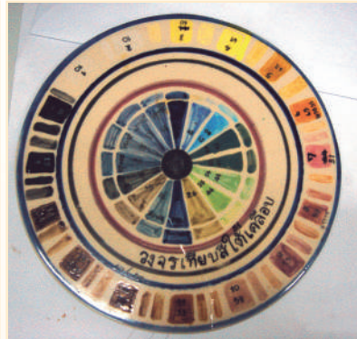
การทดลองหาน้ำหนักของสีได้เคลือบ โดยทดลองในรูปของวงจรัส
