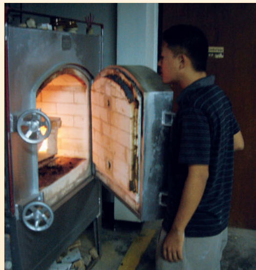
ภาพที่ ๑ ชิ้นงานขนาดเล็กที่ทดลองระบายสี ภาพที่ ๒ การนำชิ้นงานที่ทดลองเขียนสี เข้าเตาเผา เพื่อศึกษาข้อบกพร่องต่างๆ
