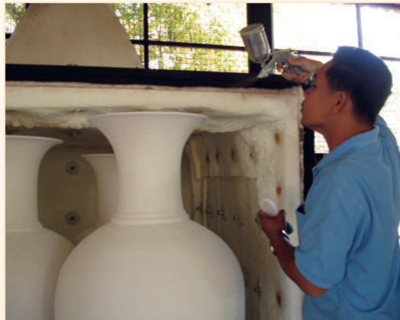
ชิ้นงานทดลองขนาดเล็กภายหลังการเผาเคลือบ พบปัญหา เรื่องสีที่บางส่วนเข้มมาก หรืออ่อนมาก บางส่วนจะเห็นเส้น ฟุ้งกันชัดเจนจนเกินไป จึงได้ทดลองระบายสีลงบนชิ้นงานขนาด เท่าของจริงอีกครั้ง
