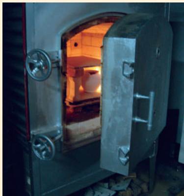
ภาพที่ ๑ ชิ้นงานขนาดเล็กที่ทดลองระบายสี ภาพที่ ๒ การนำชิ้นงานที่ทดลองเขียนสี เข้าเตาเผา เพื่อศึกษาข้อบกพร่องต่างๆ
