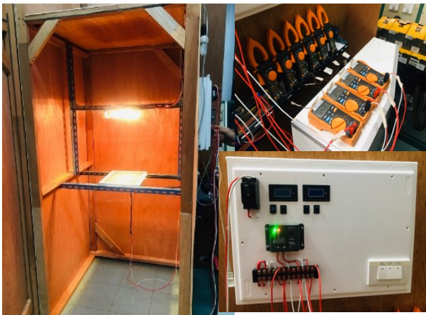
รูปที่ 8 การทดสอบประสิทธิภาพในห้องทดสอบที่ควบคุมปริมาณแสงและอุณหภูมิภายนอก
