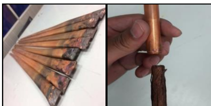
รูปที่ 3 ท่อความร้อน และวัสดุพรุนแบบตาข่าย
