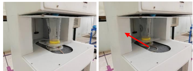
(ก) จุดวางแก้วที่ฐานรับแก้ว (ข) เคลื่อนแก้วไปยังจุดปล่อยน้ำ
