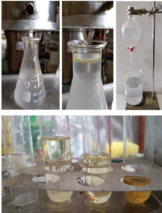
รูปที่ 4 แสดงน้ำที่ได้จากการกลั่นและการแยกน้ำมันหอมระเหย
