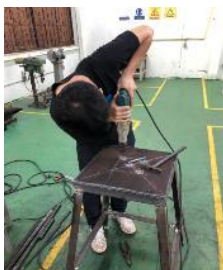
รูปที่ 4 ประกอบโครงสร้างเครื่องและฐานรอง
