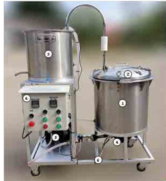
รูปที่ 3 แสดงรูปเครื่องกลั่นน้ำมันหอมระเหยที่เสร็จสมบูรณ์
