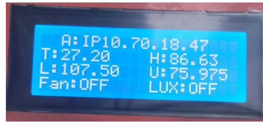
(ข) รูปที่ 4.2 การทำงานของพัดลม ถ้าสภาพแวดล้อมเหมาะสม
