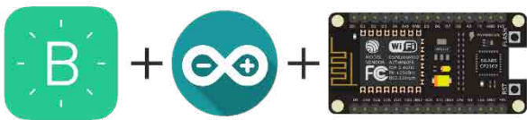
รูปที่ 4 แอปพลิเคชันบนสมาร์ทโฟนเชื่อมกับ ESP8266
