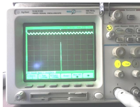
รูปที่ 4 ทดสอบสัญญาณผลการมอดูเลตทางความถี่ 100 MHz
