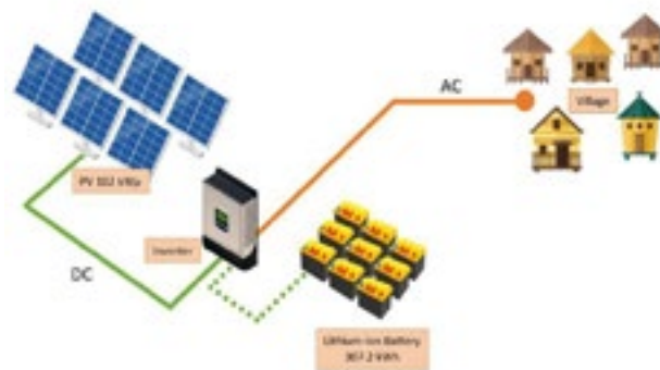
รูปที่ 1 ระบบผลิตไฟฟ้าพลังงานแสงอาทิตย์บ้านผาด่าน
