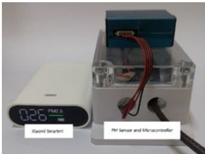
รูปที่ 8 การทดลองเปรียบเทียบการวัดค่าฝุ่นละออง
