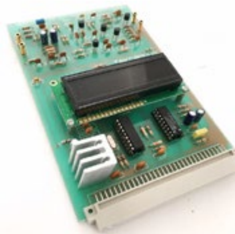
รูปที่ 3 แผงวงจรการมอดูเลตทางความถี่ที่ออกแบบสร้าง
