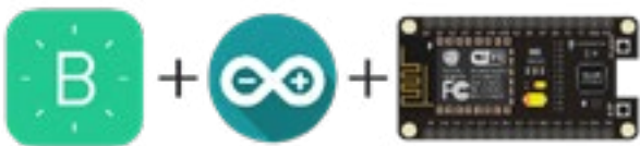
รูปที่ 4 แอปพลิเคชันบนสมาร์ทโฟนเชื่อมกับ ESP8266
