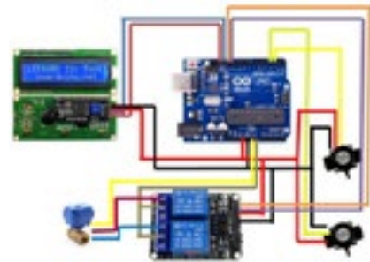
รูปที่ 5 อุปกรณ์ที่ใช้ในส่วนระบบควบคุมโปรแกรมที่ 1
