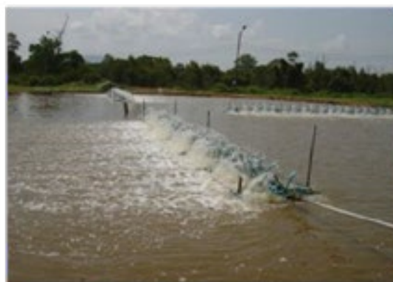
รูปที่ 1 เครื่องเติมอากาศแบบการใช้ใบพัดตีน้ำ
