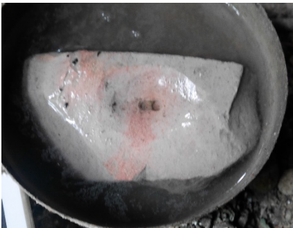
แบบพิมพ์สำหรับเทเงินที่หลอมแล้วในพิมพ์ ออกมาในรูปลักษณะของเม็ดถั่ว
