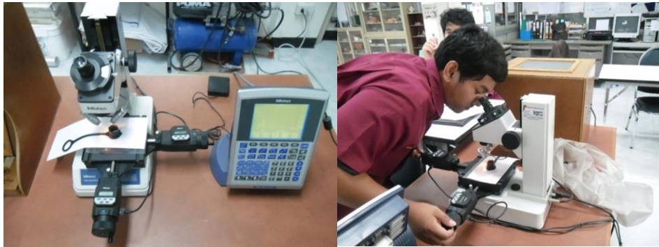
ภาพที่ 9 แสดงการตรวจสอบขนาดชิ้นงานยางเปรียบเทียบกับการออกแบบ
