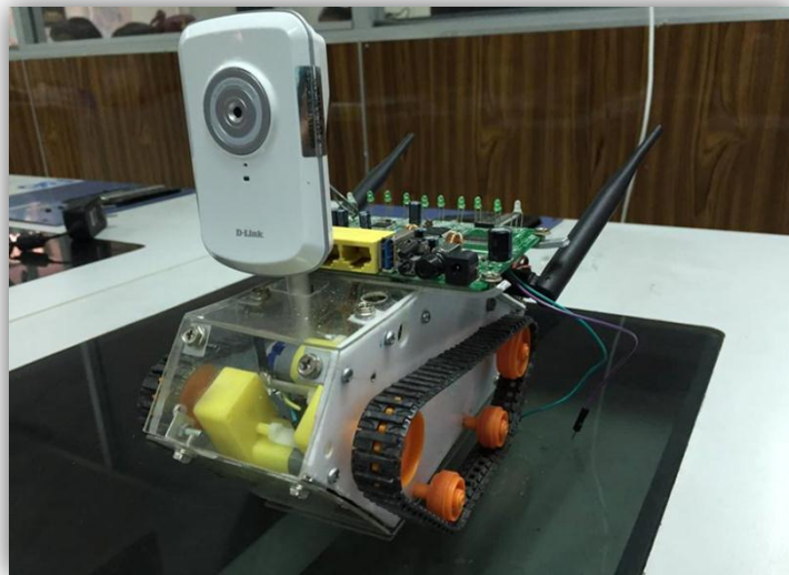
ภาพที่ 4 ตัวรถสำรวจวัตถุต้องสงสัยควบคุมผ่านระบบ Wi-Fi
