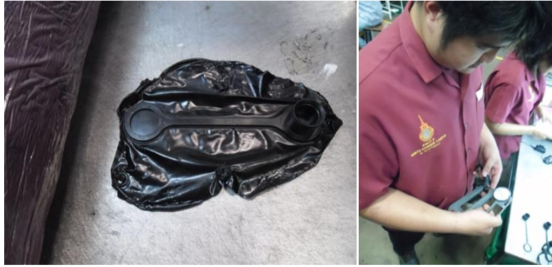
ภาพที่ 8 แสดงการตรวจสอบชิ้นงานยางหลังขึ้นรูป
