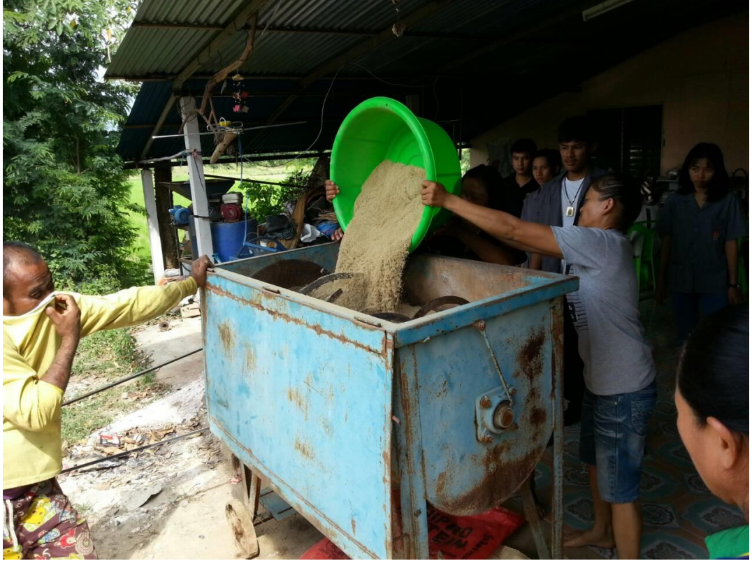
ภาพกิจกรรมที่ ๔.๓ การผสมอาหารสุกรด้วยเครื่องผสมแบบถังนอน
