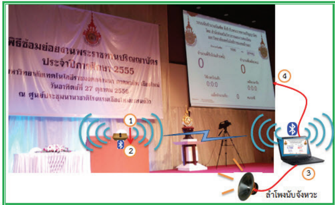
ภาพที่ 4 ขั้นตอนการทำงานของระบบนับจำนวนบัณฑิตอัตโนมัติ
