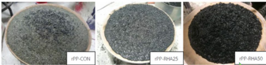
ภาพที่ 3 ลักษณะส่วนผสมคอนกรีตมวลเบา rPP-CON rPP-RHA25 และ rPP-RHA50
