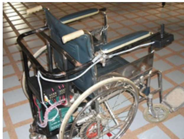
5) ชุดขับเคลื่อนไฟฟ้าเมื่อประกอบเข้ากับรถเข็นคนพิการ
