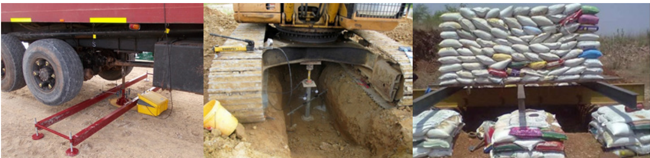
รูปที่ 2 การทดสอบการรับน้ำหนักของดินสำหรับงานก่อสร้างฐานรากอาคาร
