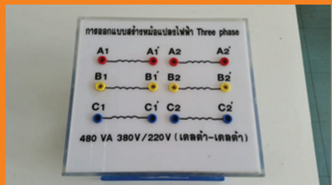
Invention – 14 ภาพแสดงการออกแบบหม้อแปลงไฟฟ้า 3 เฟส ขนาด 380/220V 480 VA โดยใช้วิธีผลคูณพื้นที่
