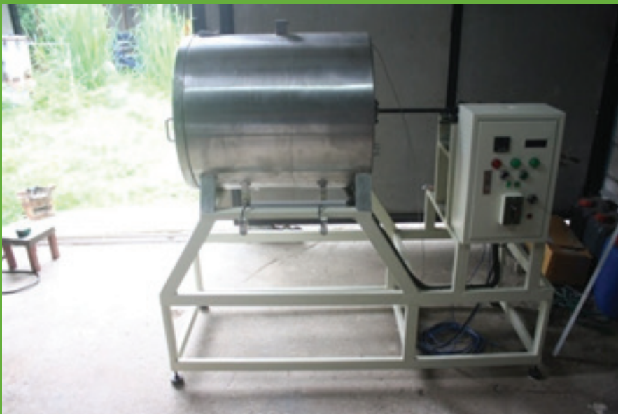
Innovation – 02 ภาพแสดงเครื่อง อบแห้งอินฟราเรดถึงหมูน
