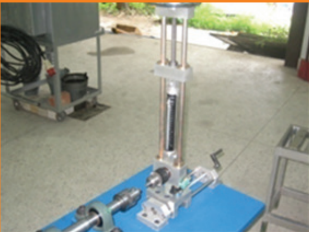
Invention – 06 ภาพแสดงการพัฒนาและสร้างเครื่องทดสอบการลำตัวของวัสดุด้วยแรงกดจากสปริง
