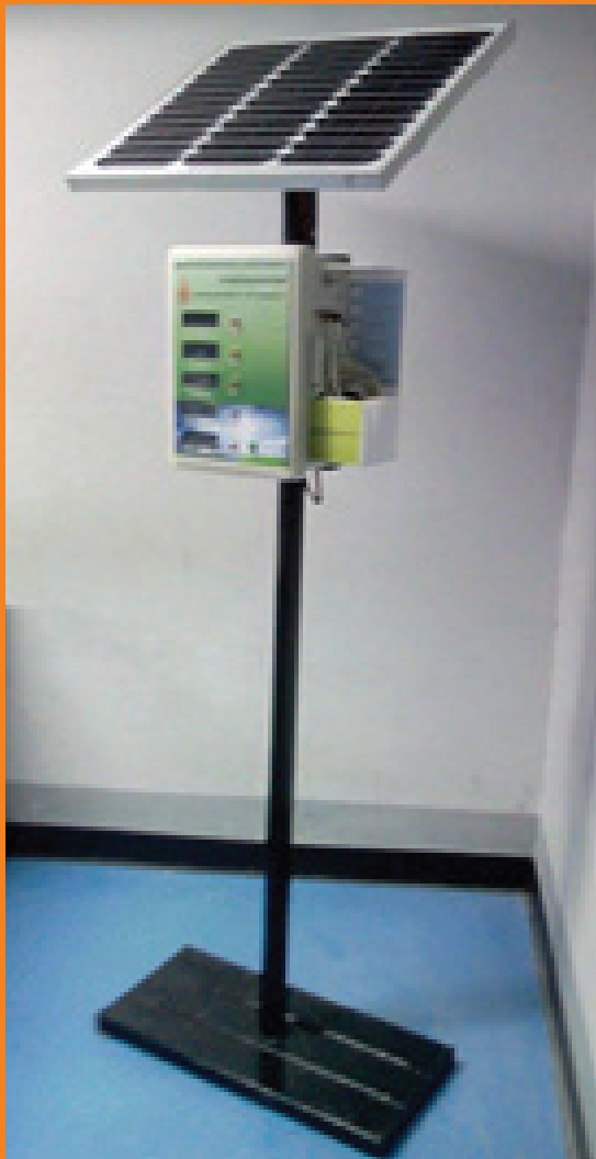
Invention – 04 ภาพแสดงชุดเครื่องมือวัดสำหรับ กระบวนการอบแห้งด้วยพลังงานแสงอาทิตย์ ภาพแสดง ชุดเครื่องมือวัดสำหรับกระบวนการอบแห้ง ด้วยพลังงานแสงอาทิตย์
