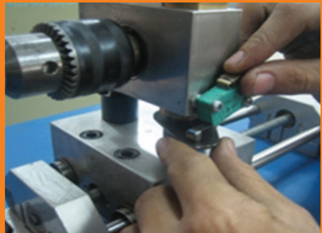
Invention – 06 ภาพแสดงการพัฒนาและสร้างเครื่องทดสอบการลำตัวของวัสดุด้วยแรงกดจากสปริง
