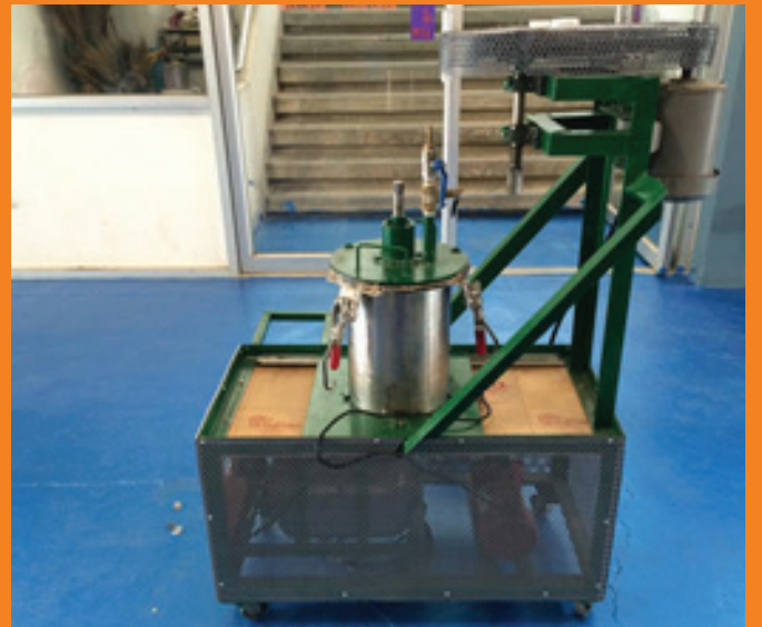
Invention – 11 ภาพแสดงเครื่องผสมปูนพลาสติก สุญญากาศ
