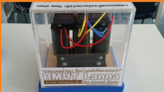
Invention – 14 ภาพแสดงการออกแบบหม้อแปลงไฟฟ้า 3 เฟส ขนาด 380/220V 480 VA โดยใช้วิธีผลคูณพื้นที่
