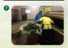
นำใบชาออกจากเครื่องเขย่าใบชา นำมาใส่ กะดังอ่อนบนตาเริ่งเท่านั้น ต้องเริ่งใบเา น้ำหนักสุทธิ 4 กิโลกรัม (แต่ต้องไม่เกิน 4.5 กิโลกรัม ) หมายเหตุ หากคิดน้ำหนัก ใบชารวมกะดัง คือ 5.8 กิโลกรัม แต่ต้อง ไม่เกิน 6.4 กิโลกรัม
