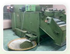
ต้องรอเครื่องอบชา ทำงาน 30 นาที/ ต่อรอบ ต้องนำมาใส่เครื่องอบมา ครั้งละ 1 ก้อน และนำกะดังและพ้าห่อมามารองรับที่ทาง ออกของเครื่องอบมา
