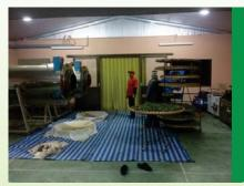
4 พนักงานต้องเตรียมชั้นพักเพื่อวาง กะดังแข็งที่หน้าเครื่องคั่ว และปพ้า รองพื้นกันเปื้อน นำใบชาออกจาก ห้องควบคมอากาศ มาเตรียมที่หน้า เครื่องคั่ว และนำกะดังอ่อนมาเตรียม รองรับใบชาที่ออกจากเครื่องคั่วชา
