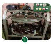
พนักงานต้องตรวจสอบเครื่องนวด อัดเม็ดเภ ตามใบบันทึกการตรวจสอบ เครื่องจักรที่กำหนด/พนักงานต้อง ตรวจสอบและทำความสะอาดเครื่อง คั่วชา ตามใบบันทึกการทำความสะอาด ตามมาตรฐาน 5ส ของโรงงานชา
