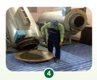
ต้องนำก้อนมาไปที่เครื่องสางใบมา เพื่อ เป็นการวนกระบวนพลิตการอัดเม็ด(การ วนกระบวนการพลิต อยู่ที่ 47 รอบ แต่ ต้องไม่เกิน 54 รอบ) หากชาอัดตัวกันจน เป็นเม็ดแล้วให้นำไปเข้าเครื่องอบชา
